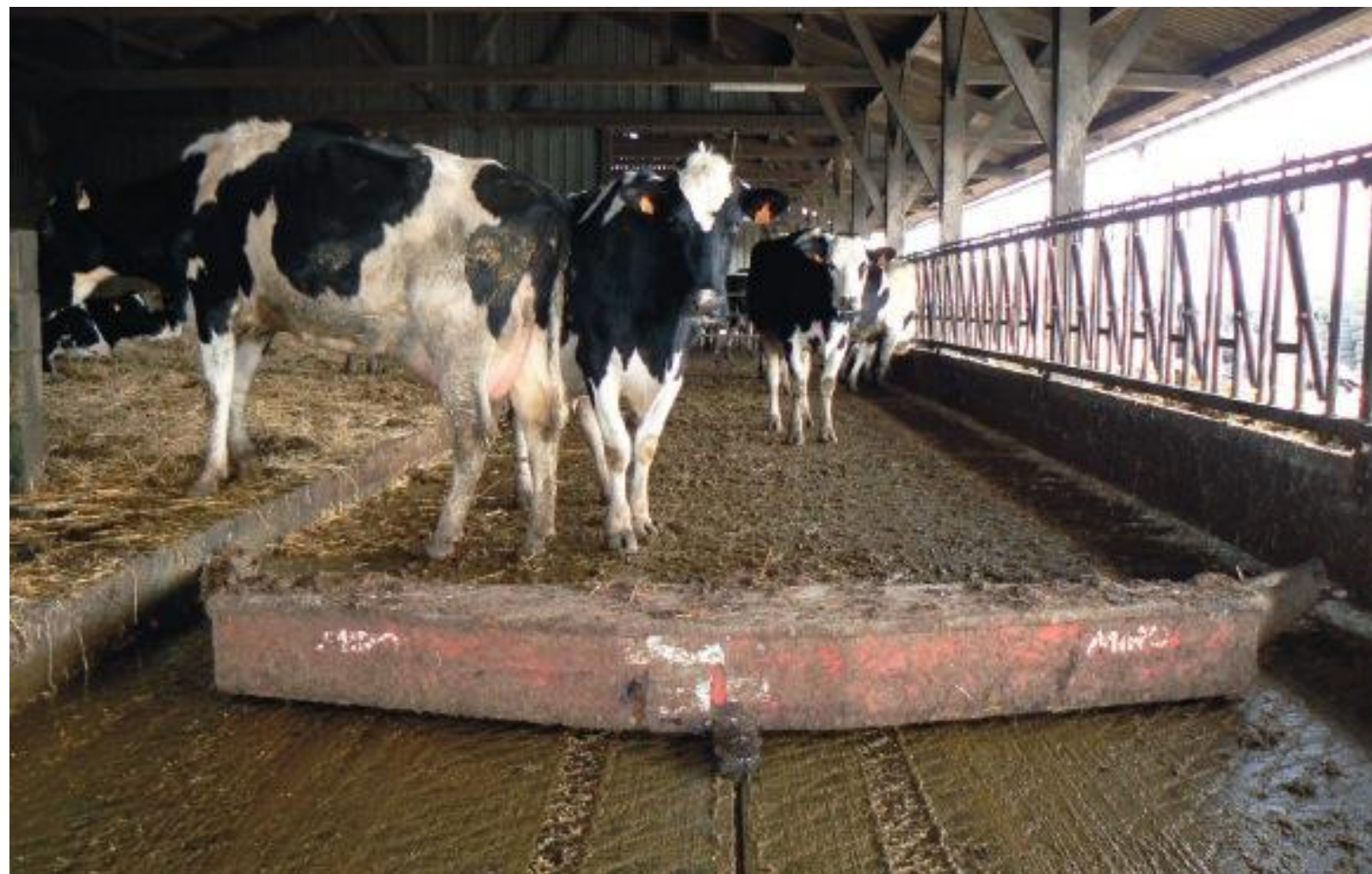
LES RACLEURS HYDRAULIQUES SONT BIEN ADAPTÉS AUX BÂTIMENTS LONGS - © V. Rychembusch
